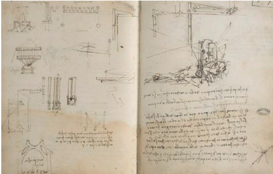
Dibujo de máquina voladora con mecanismo accionado por manos y pies. (Códice Francia, Paris Ma. Fol 79r).
